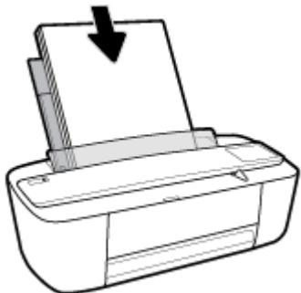
3. 向右滑动纸张宽度导轨，直到触及纸张边缘。
