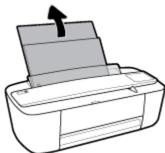
2. 将一叠照片纸放入进纸盒的最右边，短边朝下、打印面朝上，然后向下滑动纸叠，直到不能移动为止。
