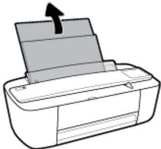
2. 将一叠纸短边朝下、打印面朝上放入进纸盒中，向下推纸叠，直到遇阻为止。
