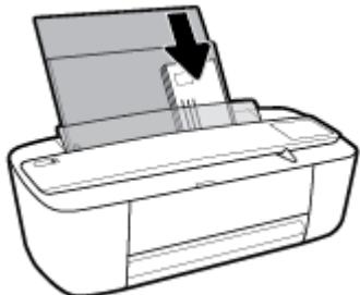
3. 向信封滑动纸张宽度导轨，直到停止为止。
