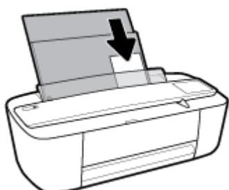
3. 向右滑动纸张宽度导轨，直到触及纸张边缘。
